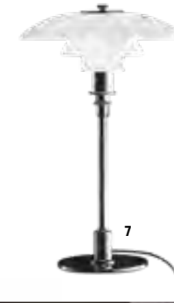
7 PH 3/2 TISCHLEUCHE Poul Henningsen Die Leuchte wurde ausgehend vom Prinzip eines reflektierenden Dreischirmsystems gestaltet, das den größten Teil des Lichts nach unten leitet. Die Schirme sind aus mundgeblasenem, opalisiertem, dreischichtigem Glas hergestellt, was zu einer weichen und diffusen Lichtverteilung führt.
